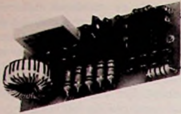
Afb. 16 Dimmerprint, klaar voor inbouw in kastje.
